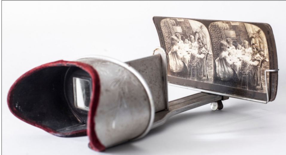
Visor estereoscópico y estereoscopía montada para su visionado Foto: Atilio Orellana. Colección privada
